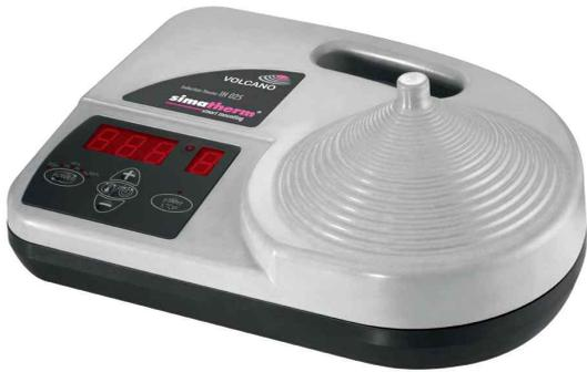
Simatherm IH 025 VOLCANO는 내경 20mm에서 최대 외경 160mm까지 이르는 롤러베어링이나 원형금속을 간편하고 빠르게 가열할 수 있고 온도 또는 시간을 제어하여 손쉬운 가열이 가능한 고주파 유도 가열기입니다. 이상적인 가열온도 조건은 110°C 로 공식화되어 효과적인 가열을 돕고 최대 180°C까지 가열가능한 제품이기 때문에 다른 원형금속들 또한 작업이 수월합니다.
