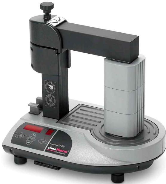
Simatherm IH 090은 내경 400mm까지 이르는 롤러베어링이나 원형금속을 간편하고 빠르게 가열할 수 있고 온도 또는 시간을 제어하여 손쉬운 가열이 가능한 고주파 유도 가열기입니다. 이상적인 가열온도 조건은 110°C 로 공식화되어 효과적인 가열을 돕고 최대 250°C까지 가열가능한 제품이기 때문에 다른 원형금속들 또한 작업이 수월합니다.
