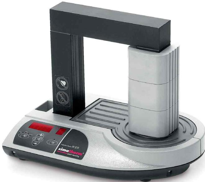
Simatherm IH 070은 내경 400mm까지 이르는 롤러 베어링이나 원형금속을 간편하고 빠르게 가열할 수 있고 온도 또는 시간을 제어하여 손쉬운 가열이 가능한 고주파 유도 가열기입니다. 이상적인 가열온도 조건은 110°C 로 공식화되어 효과적인 가열을 돕고 최대 250°C까지 가열가능한 제품이기 때문에 다른 원형 금속들 또한 작업이 수월합니다.
